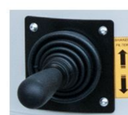
scuotimento filtro meccanico
