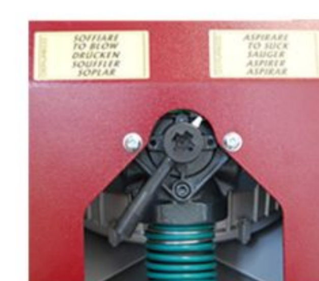
sistema a flusso inverso aria dalla turbina
